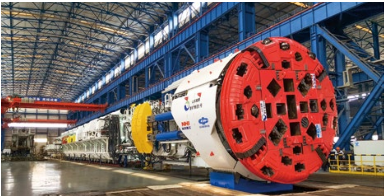
建设集团联合研发拥有自主知识产权的国内首台煤矿岩巷全断面掘进机顺利始发，填补了我国敞开式 TBM 在大直径、大埋深、长距离煤矿岩巷施工空白，创造了最高月进尺 310m 的“大世界基尼斯之最”施工记录。
